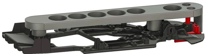
Se verificaran con el siguiente útil, las carrocerías para evitar deformaciones: 143mm longitud total
