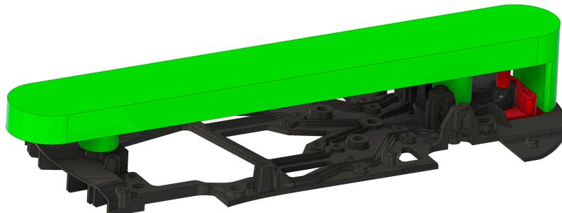
Se verificaran con el siguiente útil, las carrocerias para evitar deformaciones: 141,3mm longitud total. Se verificará también el ancho de la carroceria.
